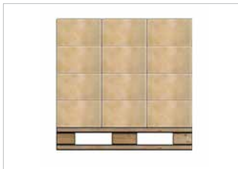
Rozměry skladované jednotky a palety jsou stejné, jako rozměry palety, jednotka a palety stojí rovně.
