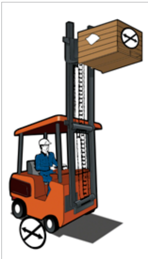
obr. 1. Nejezdit se zdviženým nákladem.
