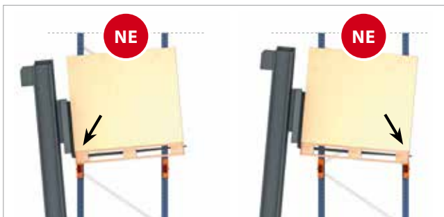
obr. 9. Přetížení nosného trámu následkem spouštění, které není vykonáno vodorovně.
