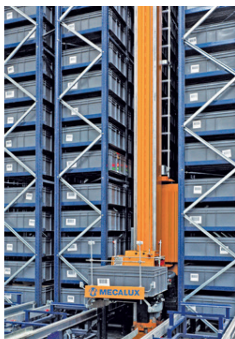
Zakladač se dvěma sloupy MBL (Umožňuje současnou obsluhu čtyř nádob s hmotností do 50 kg, do výšky až 20 m).
