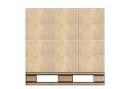
Stejné rozměry a rovné postavení nákladu a palety
